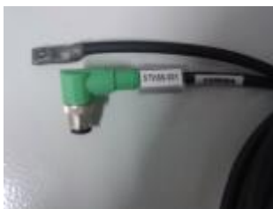
Figure 57 : Capteur T/HR ST 55 (Newsteo)
