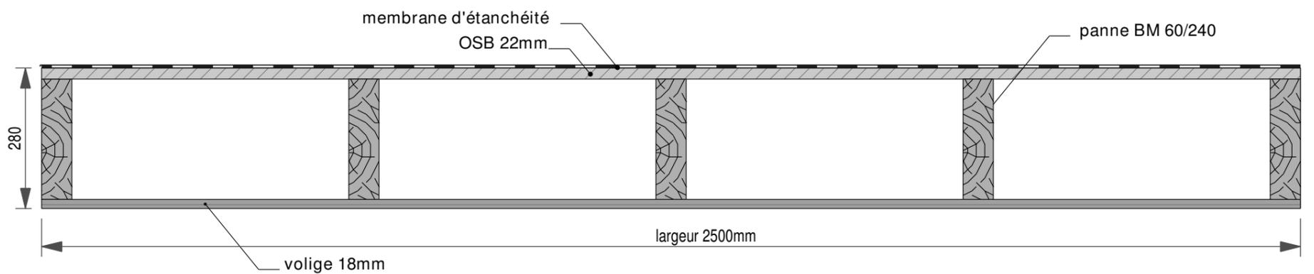
Caisson de toiture non-isolé
