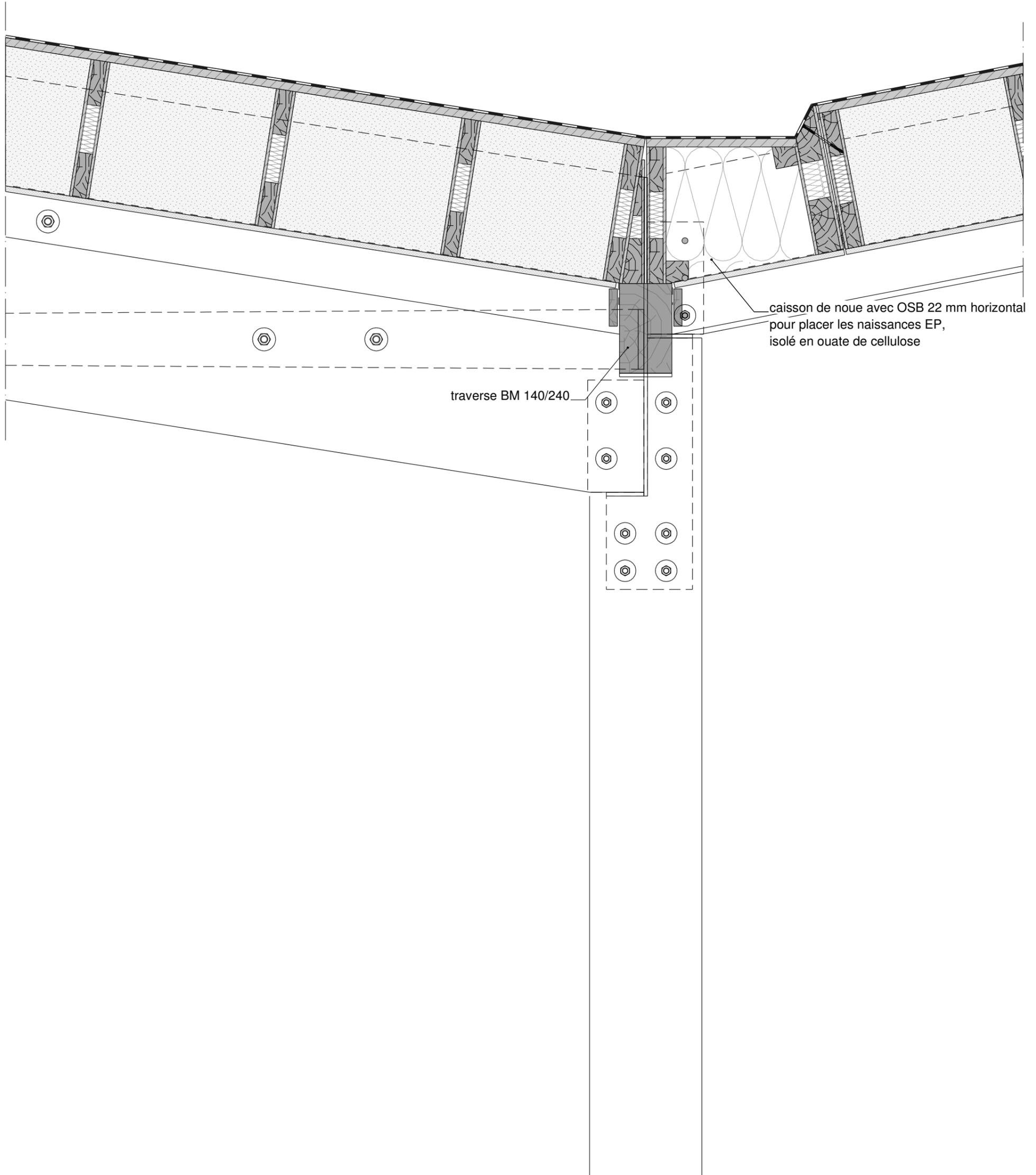
caisson de noue avec OSB 22 mm horizontal pour placer les naissances EP, isolé en ouate de cellulose
