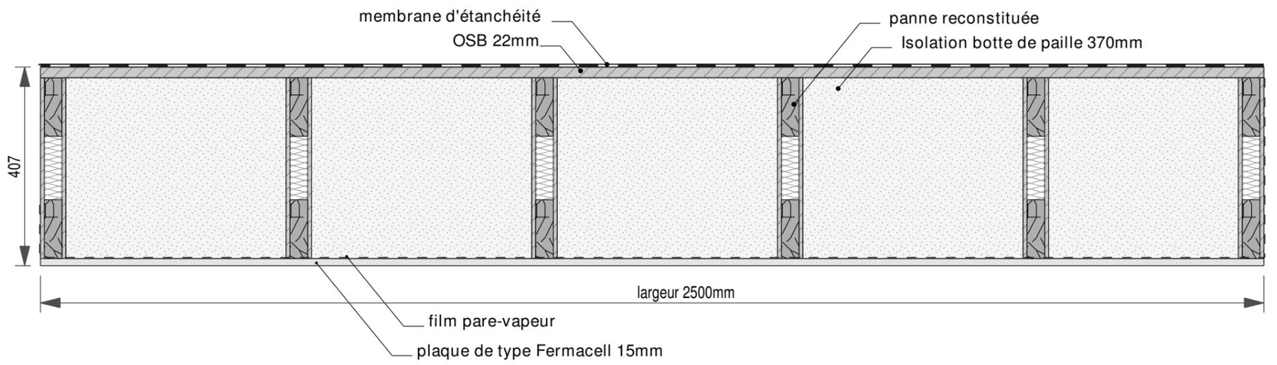
Caisson de toiture isolé
