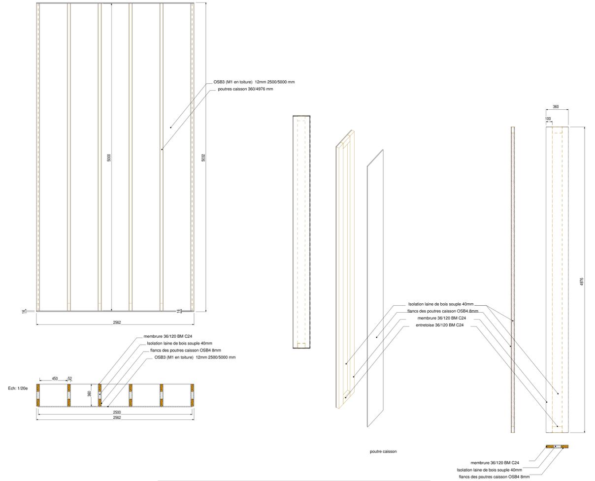
PRINCIPE DES CAISSONS PAILLES EN MUR ET TOITURE éch.1/20
