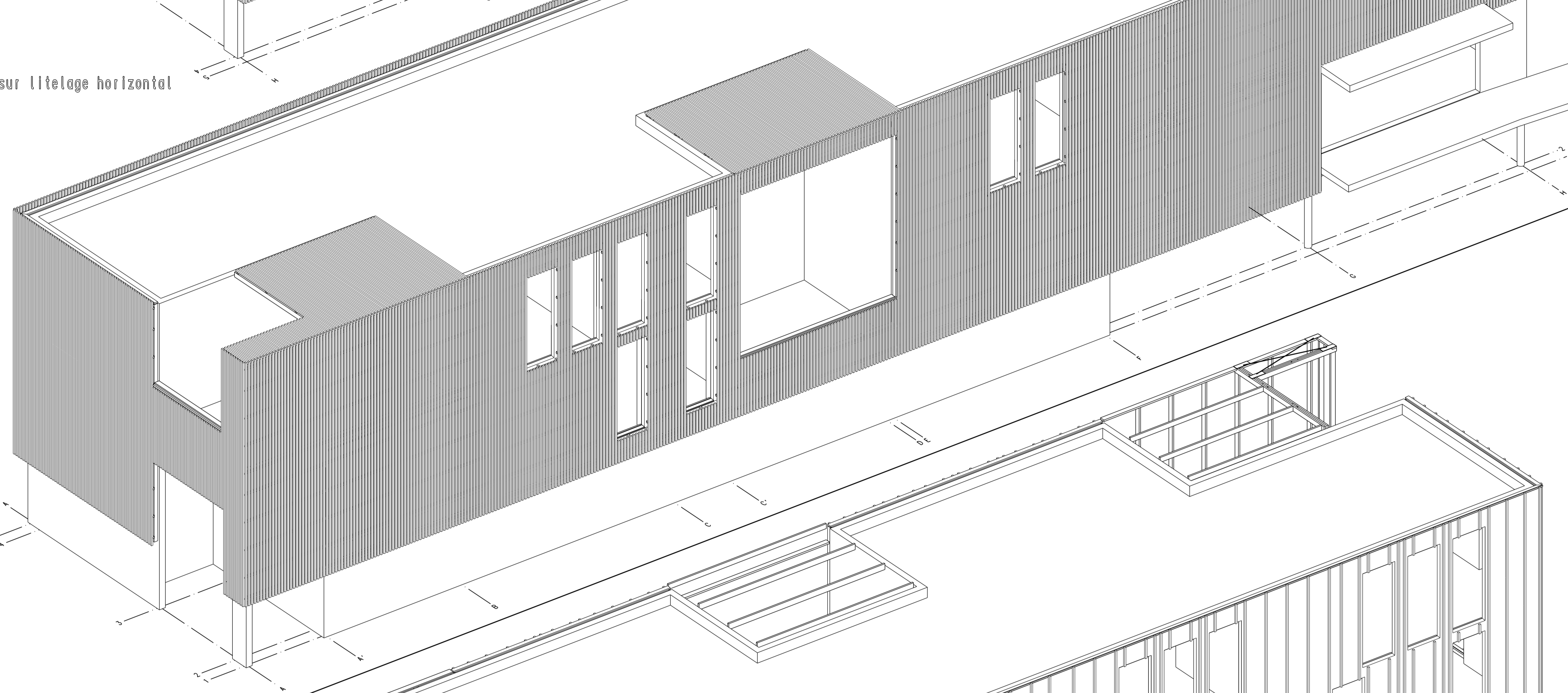
Axonométrie SUD-EST / Bardage sur litielage horizontal
