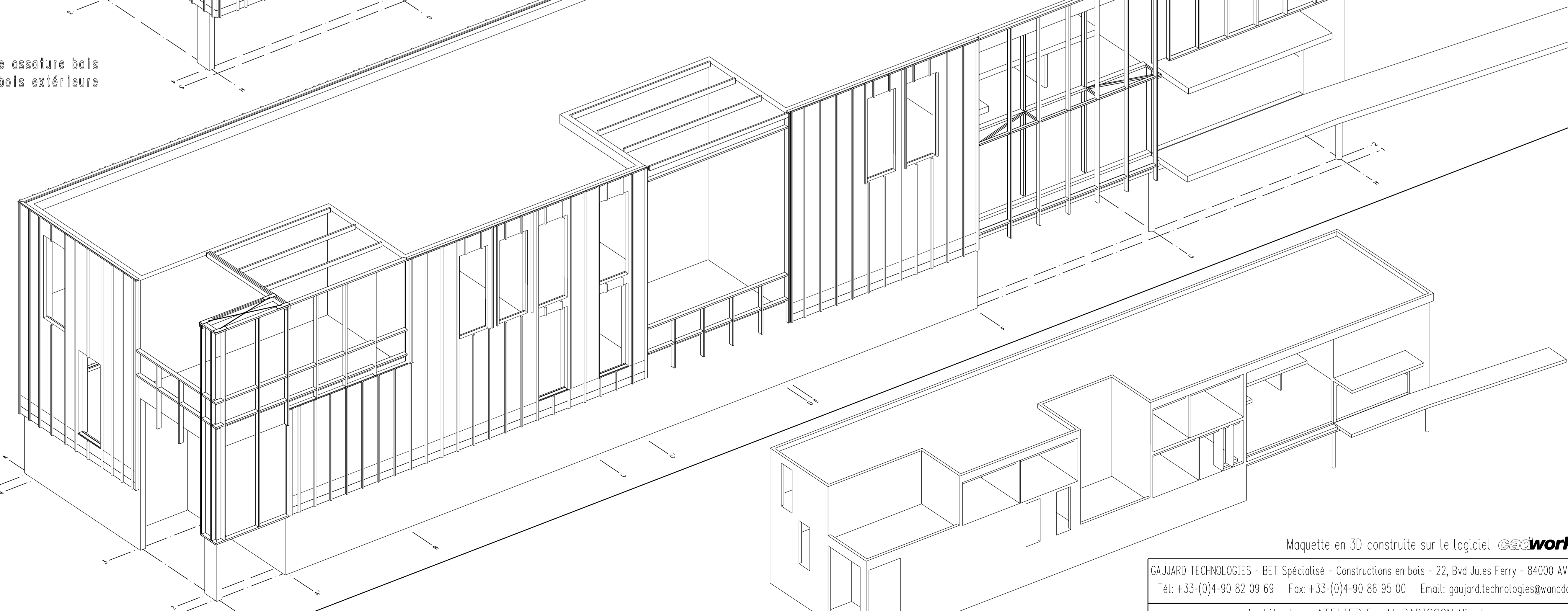
Axonométrie SUD-EST / Structure béton seule
