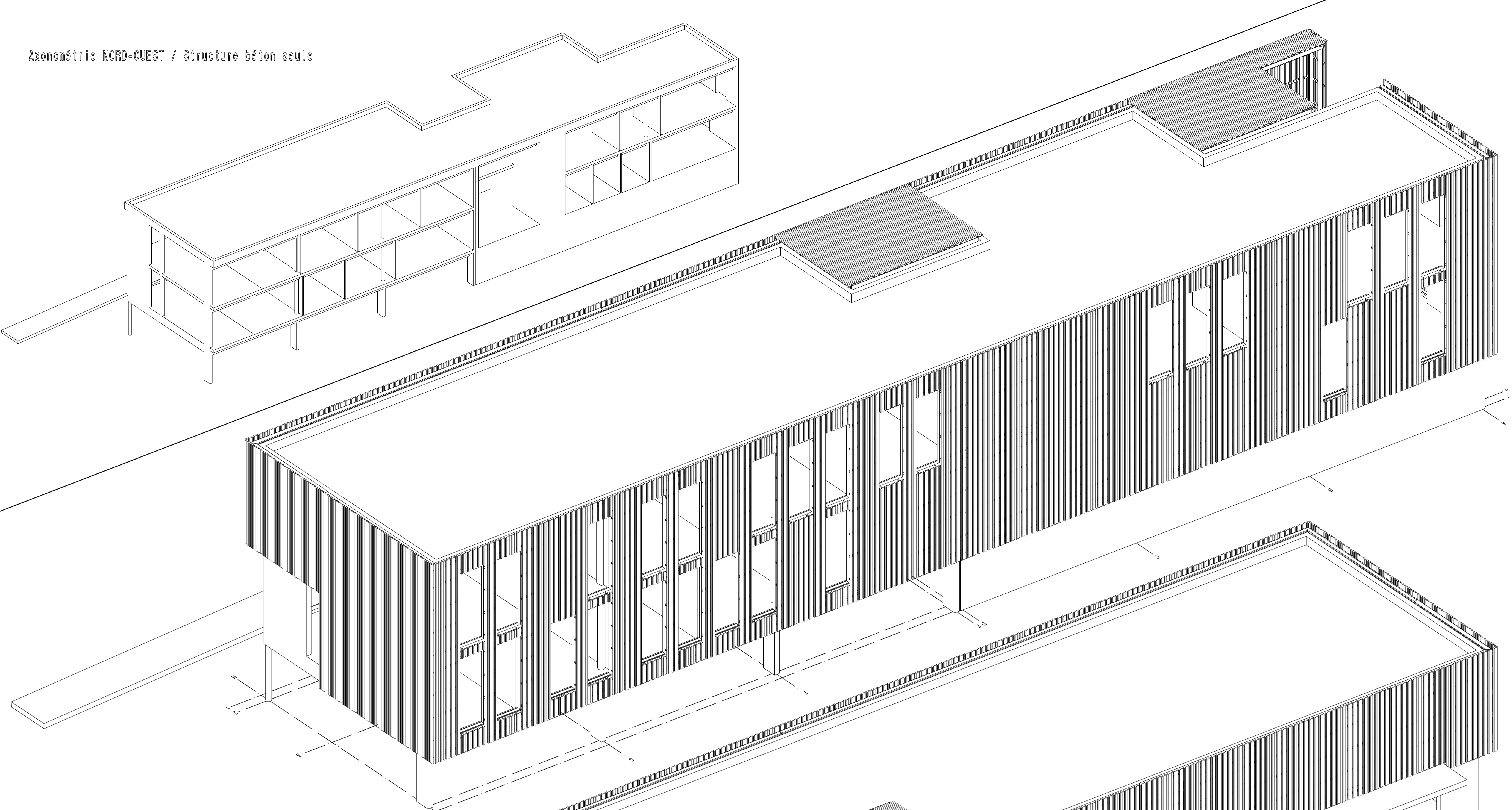
Axonométrie NORD-OUEST / Bardage sur litielage horizontal
